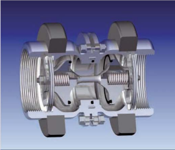
Series of ABV before emergency disconnect (ABV-Serie vor Nottrennung)
